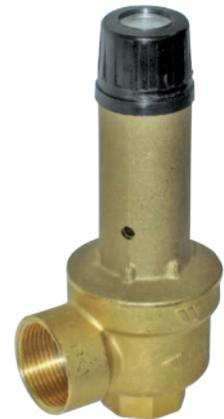
La valvola di intercettazione del combustibile è una valvola di sicurezza ad azione positiva tarata a banco. Montata sulla tubazione di alimentazione del gas, ha lo scopo di intercettare il suo afflusso al generatore, per evitare il raggiungimento della temperatura di ebollizione nel circuito di mandata. Essendo un dispositivo ad azione positiva, in caso di guasto dell'elemento sensibile o di rottura del capillare, la valvola si chiude automaticamente senza possibilità di riarmo.
