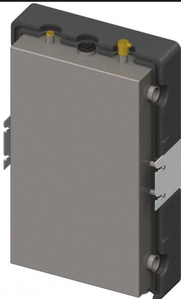
Mini accumulo inerziale ultrapiatto da 50 litri che può gestire fino a due fonti energetiche (es. pompa di calore, caldaia o altro), svolgere le funzioni da separatore idraulico e da collettore di distribuzione per 2 zone impianto.
