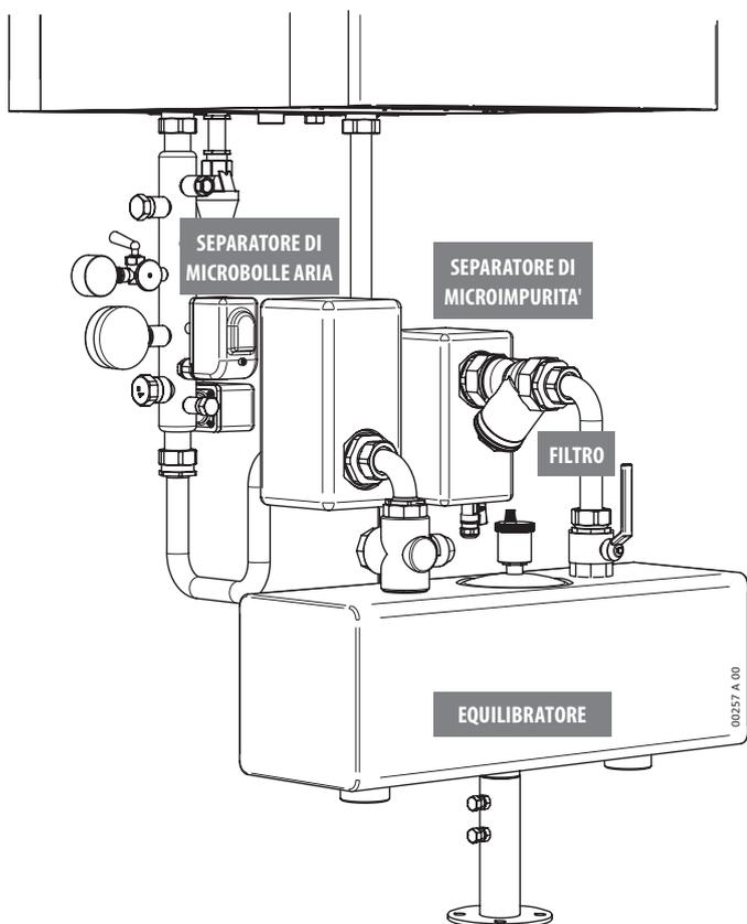
In alternativa a questi particolari è possibile utilizzare anche scambiatori a piastre, con le caratteristiche che richiede l'impianto in esame al momento. In ogni caso è sempre indispensabile inserire sulla mandata caldaia scambiatore almeno un sistema di separazione per microbolle d'aria. L'acqua di caricamento impianto deve sempre essere trattata come sopra indicato.
