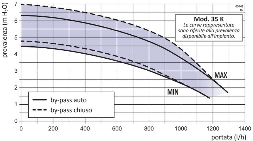
**Nota:** la curva MAX è riferita alla potenza massima del circolatore, la curva MIN è determinata elettronicamente. Il circolatore, di tipo a modulazione continua elettronica, può funzionare in un punto qualsiasi tra le due curve.
