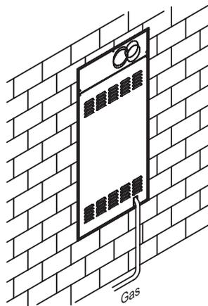
**(i)** Il box dev'essere installato **incassato completamente** nel muro, in modo che il pannello frontale sia a filo con la superficie esterna del muro e che non sporga da esso.
