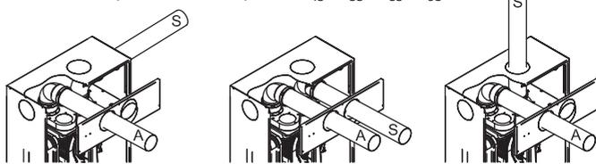
Esempi di sistemi con aspirazione diretta B<sub>23</sub>
