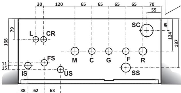
**Nota:** in previsione, in futuro, d'installare kit solare, si suggerisce di predisporre l'attacco **IS** proveniente dal punto d'installazione del Sistema Solare. Inoltre, si suggerisce di predisporre gli attacchi dell'acqua fredda e calda nelle posizioni **FS** e **US** al posto di **C** ed **F** e di collegare provvisoriamente la caldaia agli stessi per mezzo di raccordi flessibili da 1/2" (da commercio).
