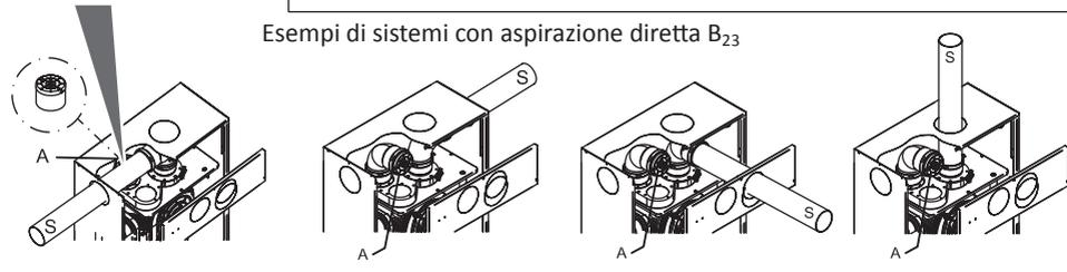
**(i)** Vedere "Tabelle lunghezze sistemi" a pagina 25 per dimensionare i condotti in funzione di: modello di caldaia; tipo di gas combustibile; distanza da coprire; diametro dei sistemi.
