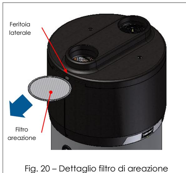
Fig. 20 – Dettaglio filtro di areazione
