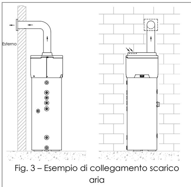
Fig. 3 – Esempio di collegamento scarico aria
