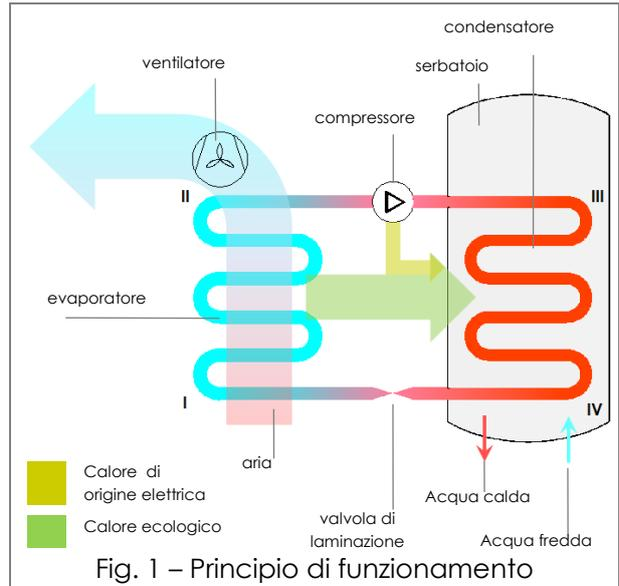
Il principio di funzionamento dell'apparato è il seguente (Fig. 1):
