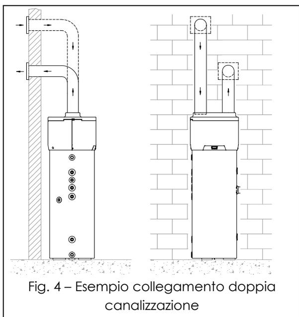
Fig. 4 – Esempio collegamento doppia canalizzazione
