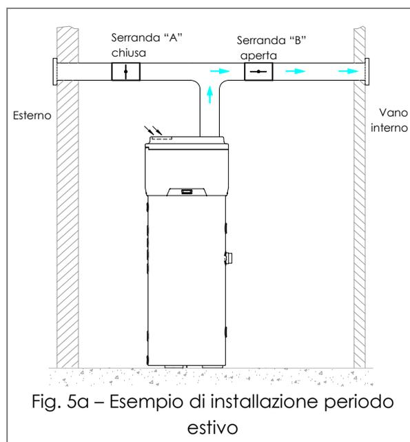
Fig. 5a – Esempio di installazione periodo estivo
