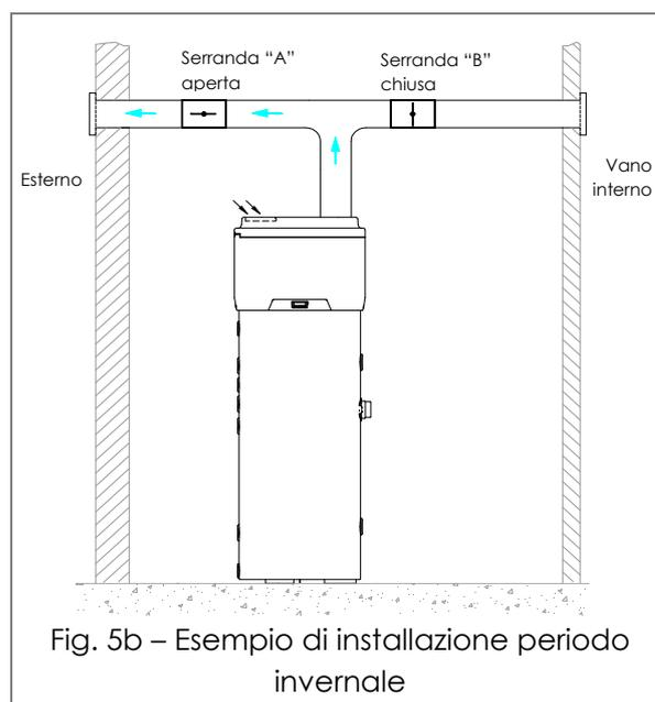
Fig. 5b – Esempio di installazione periodo invernale
