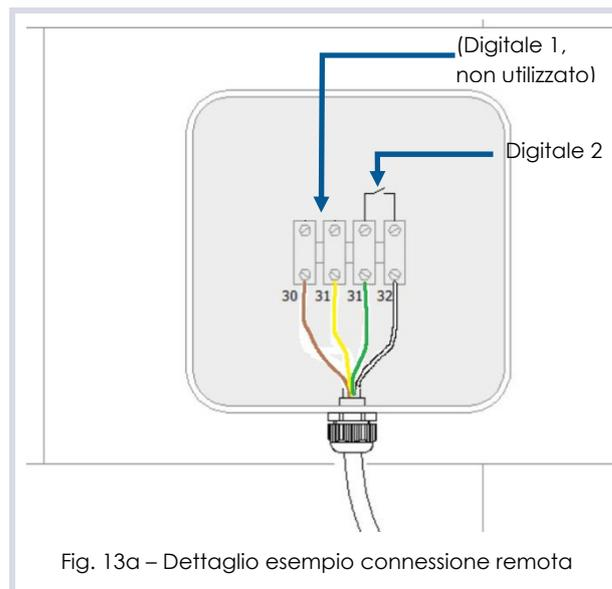
Per accedere al cavo quadripolare per connessione remota è necessario rimuovere la copertura superiore del boiler (vedi paragrafo 8.1 Fig.18), e portare all'esterno il cavo attraverso l'apposita feritoia già presente sulla cover posteriore come indicato in Fig. 14.
