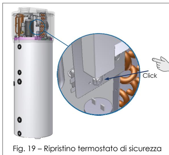
Fig. 19 – Ripristino termostato di sicurezza
