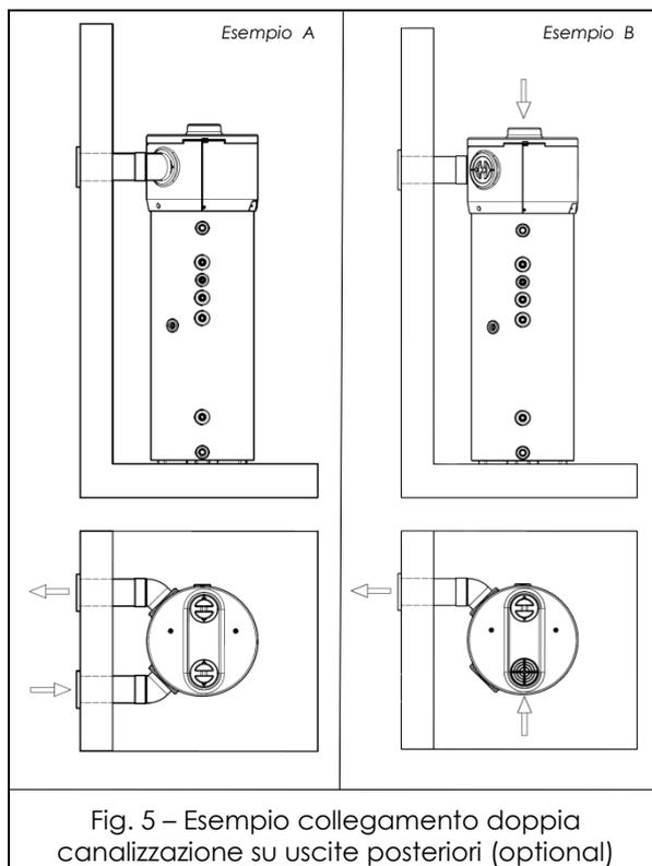
Fig. 5 – Esempio collegamento doppia canalizzazione su uscite posteriori (optional)
