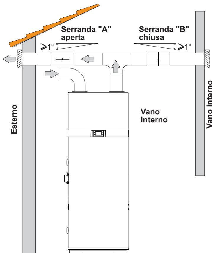
fig. 14 - Esempio d'installazione nel periodo invernale
