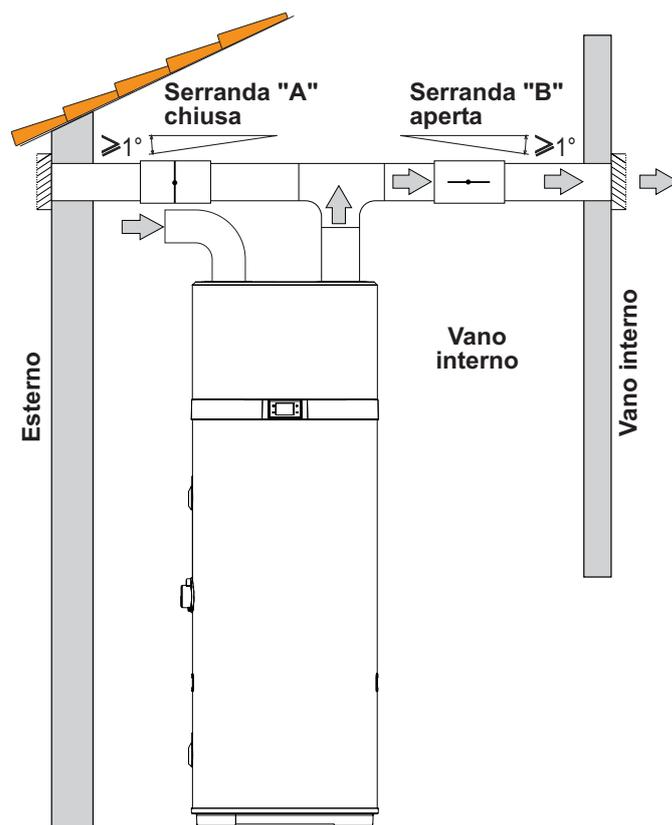
fig. 13 - Esempio d'installazione nel periodo estivo
