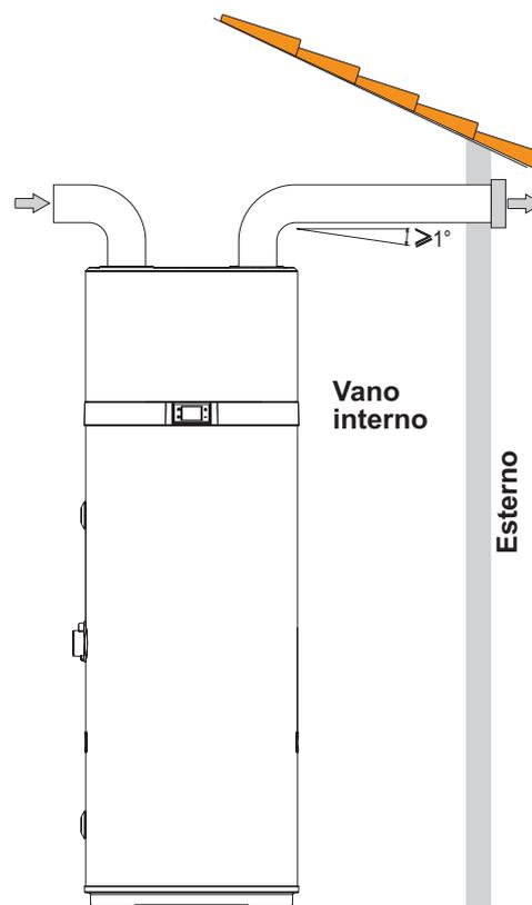
fig. 12 - Esempio di collegamento scarico aria
