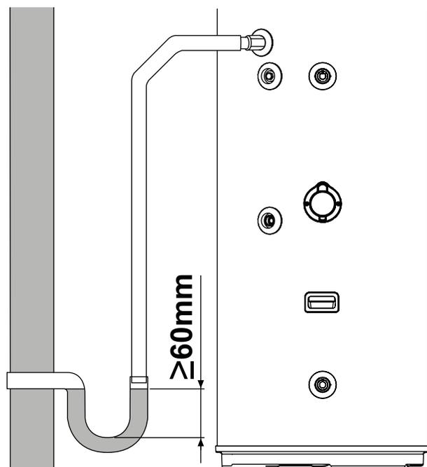
fig. 17 - Esempi di collegamento scarico condensa mediante sifone
