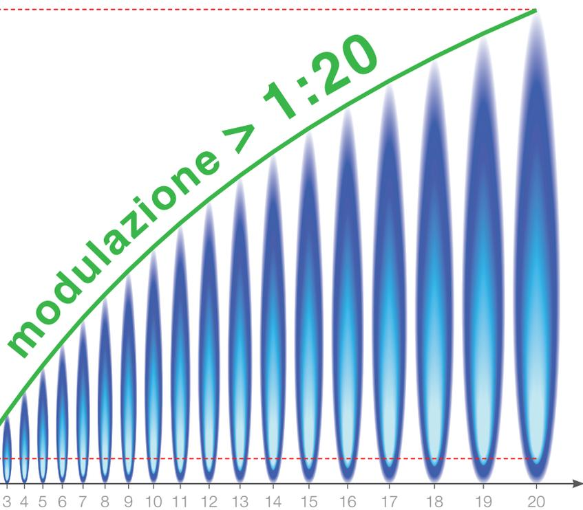
**City Top** è l'unica caldaia sul mercato con un range di **modulazione superiore a 1:20**.
