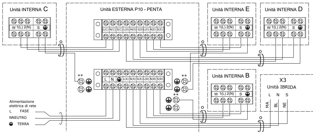
\* Il morsetto W NON è utilizzato. Non collegare. \*\* Utilizzare il morsetto di terra libero più vicino. Collegare un solo conduttore di terra per ogni morsetto.
