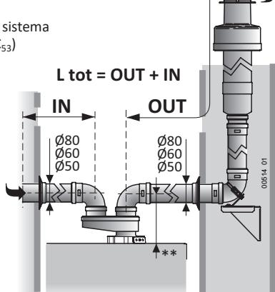
\* Nota: Con il sistema separato è possibile realizzare anche sistemi di tipo  $C_{13}$  e  $C_{33}$ .
