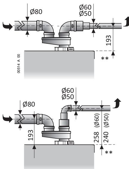
L'altezza dell'asse del condotto orizzontale\*\* dipende dalla presenza del riduttore (da Ø80mm a 60 o 50mm) e dal suo posizionamento:
