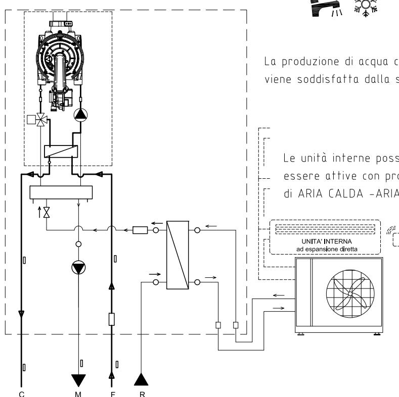
La produzione di acqua calda sanitaria viene soddisfatta dalla sola caldaia
