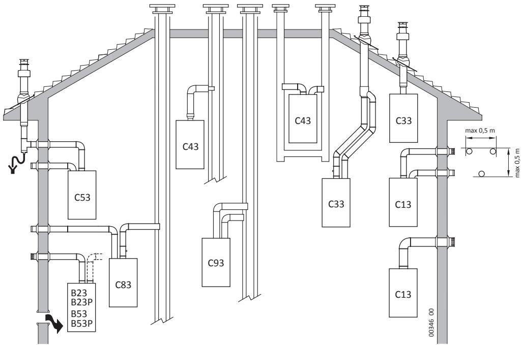
Il condotto di scarico ed il raccordo alla canna fumaria devono essere realizzati in conformità alle Norme e alla Legislaione nazionale e locale in vigore. – È obbligatorio l'uso di condotti resistenti alla temperatura, alla condensa, alle sollecitazioni meccaniche e a tenuta. – Condotti di scarico non isolati sono potenziali fonti di pericolo.
