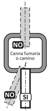
L'apparecchio è provvisto di termostato di sicurezza tiraggio camino, il quale interviene nel caso di un ritorno in ambiente dei prodotti della combustione. **Questo dispositivo non deve mai essere messo fuori servizio.** I prodotti della combustione se rientrano nell'ambiente possono causare intossicazioni croniche o acute con pericoli mortali. **Se dovesse essere sostituito il termostato è obbligatorio utilizzare solo il ricambio originale.**
