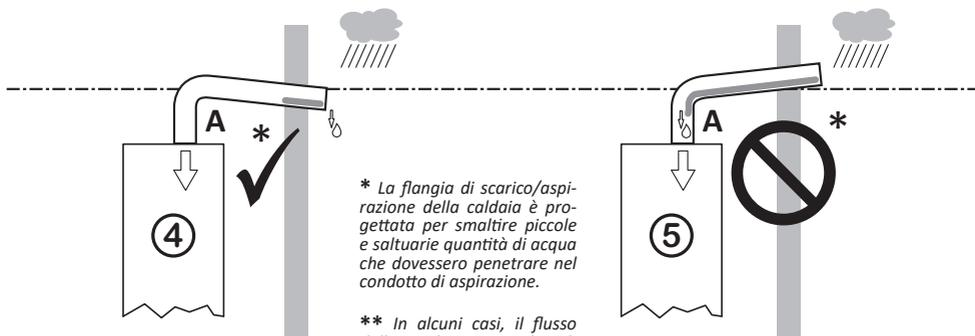
\* La flangia di scarico/aspirazione della caldaia è progettata per smaltire piccole e saltuarie quantità di acqua che dovessero penetrare nel condotto di aspirazione.
