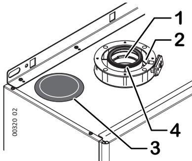
**(i)** Prima di installare l'accessorio di partenza fumisteria (scarico fumi o attacco aspirazione+scarico coassiale) **controllare la presenza ed il corretto posizionamento della guarnizione 4.**
