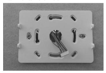
Collegare l'estremità del CONNETTORE CONTROLLO REMOTO sul retro del CONTROLLO REMOTO.
