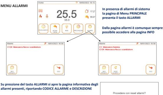
Se è presente un allarme che può essere ripristinato tramite RESET si visualizza anche il tasto di RESET ALLARMI
